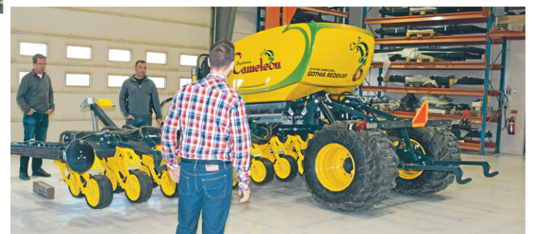
MÅNGSYSSLARE. Multimaskinen Camelion, som utvecklats av Gothia Redskap i Fornåsa, är ett modernt exempel på innovationsandan inom de gröna näringarna i Sverige. Med en och samma maskin kan man harva, så, göda och radhacka.
